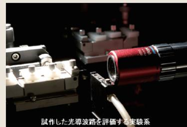
試作した光導波路を評価する実験系
