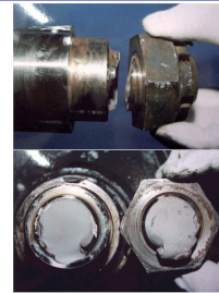
図1 破断した車軸とその破断面
