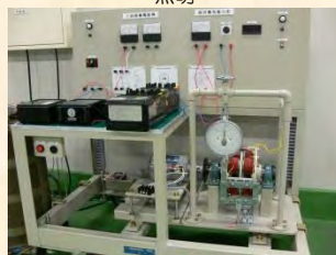
変圧器・誘導電動機
