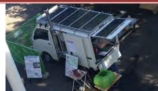
木質バイオマス燃料スターリングエンジン 発電機搭載非常用電源車
