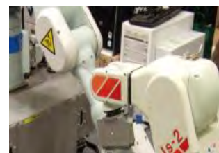
2台のロボットアームの協調による飲料缶の蓋開け動作
