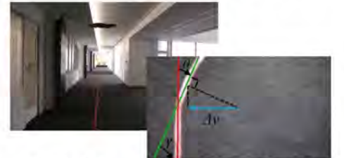
ライトレースによるドローン自動制御
