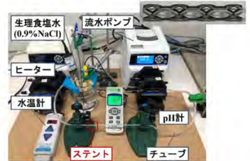
腐食試験の様子とステント形状
