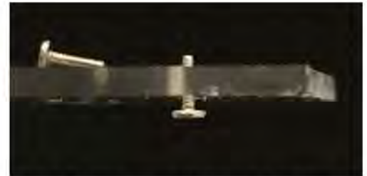
ガラス基板に作製したS0.5ミニチュアめねじに市販のS0.5おねじを差し込んだ
