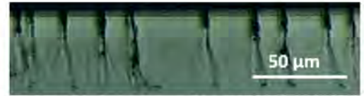
連続的に加工しているのになぜか間欠的なパターンができてしまう(ガラスの内部加工)
